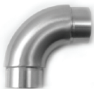
CURVA A 90° PER TUBO Ø 42,4 X 2 AISI 304 AISI 316 SATINATO
